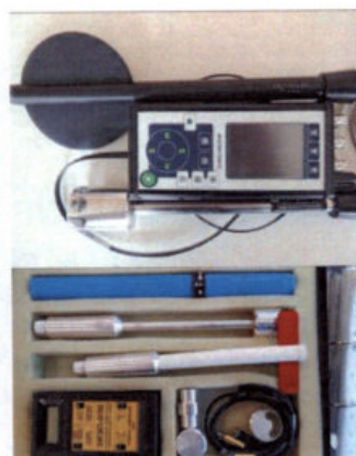
Рисунок 44. Средства передачи размера единицы НЭП Экофизика КЭП-05 и ЭИЭП-0/50
