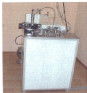
Рисунок 40. Эталонный генератор влажного газа в области отрицательных температур термостатирования
