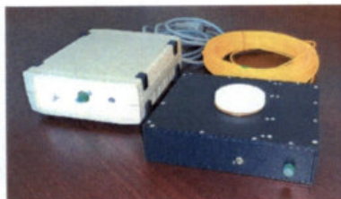
Рисунок 54. Радиооптический измерительный преобразователь напряженности импульсного электрического поля
