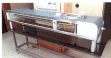
Рисунок 53. Полеобразующая система ПС-2 для воспроизведения импульсных электрического и магнитного полей в субнаносекундном диапазоне
