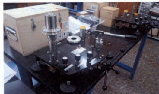
Рисунок 33. Грузопоршневые манометры МГП (диапазон от 5 кПа до 100 кПа)
