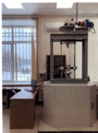
Рисунок 23. Эталонная установка для воспроизведения чисел твёрдости Бринелля (диапазон прикладываемых усилий от 1838,4 Н до 29421 Н)
