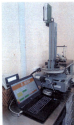
Рисунок 32. Микроманометр МКШ (диапазон от 100 Па до 5000 Па)
