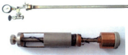
Рисунок 34. Базовый погружной криостат БКД со сменной ячейкой теплопроводности
