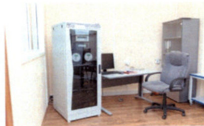
Рисунок 38. Пульт управления эталонным генератором, реализующим метод фазового равновесия, и эталонным генератором в области отрицательной температуры термостатирования
