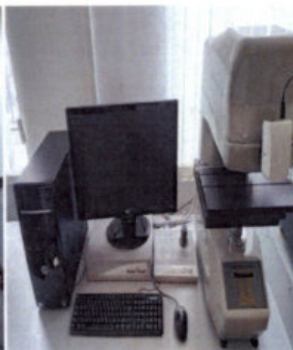
Рисунок 25. Эталонная установка для воспроизведения чисел твёрдости Бринелля (прикладываемое усилие 9,807 Н)
