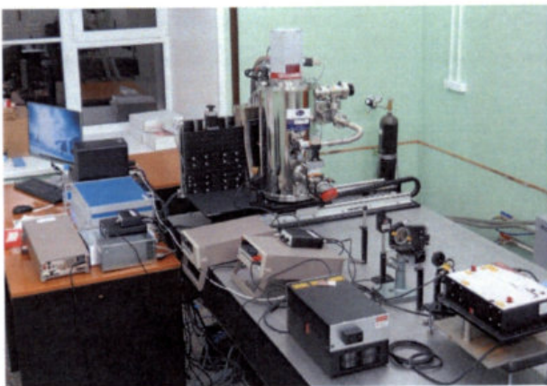
Рисунок 27. Установка для измерения мощности теплового излучения
