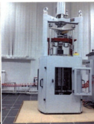
Рисунок 24. Эталонная установка для воспроизведения чисел твёрдости Бринелля (диапазон прикладываемых усилий от 49,04 Н до 1225,9 Н)
