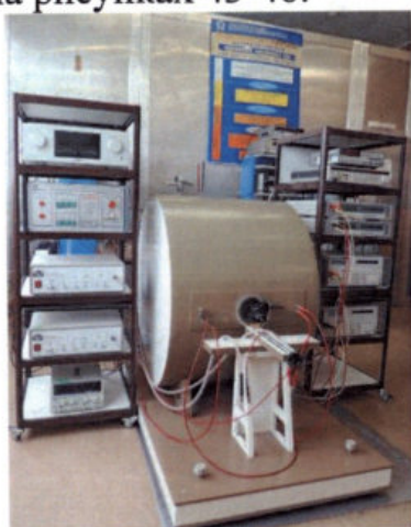
Рисунок 43. Генератор НЭП и полеобразующая система ГЭТ 158-2020
