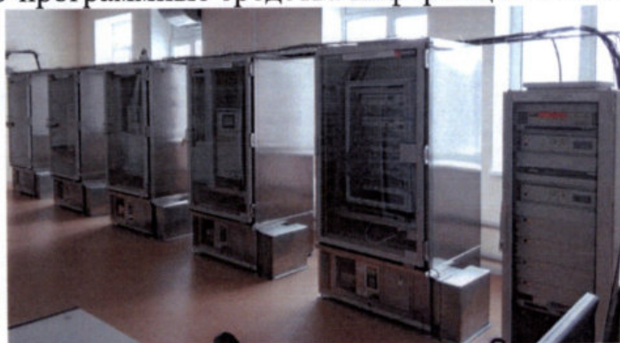
Рисунок 4. Комплекс хранения национальной шкалы времени ГЭТ1
