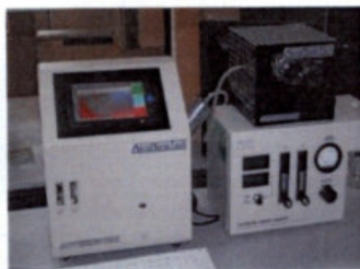
Рисунок 48. Аппаратура для передачи и воспроизведения единиц дисперсных параметров наночастиц в аэродисперсной среде, реализующая метод диффузионной аэрозольной спектрометрии
