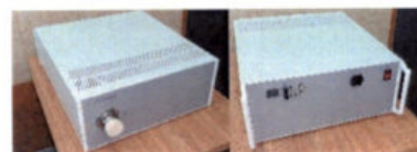
Рисунок 55. Полупроводниковый генератор импульсов высокого электрического напряжения (длительность фронта импульсов не более 100 пс, амплитуда импульсов до 50 кВ)
